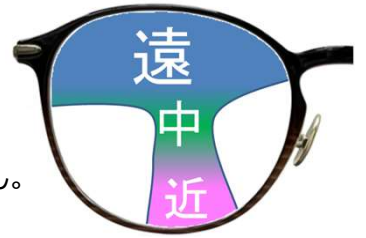
図1 遠近両用メガネの構造
