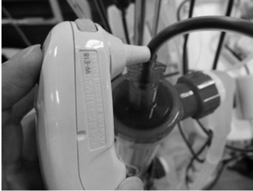
図2 赤外線式温度計による温度測定
